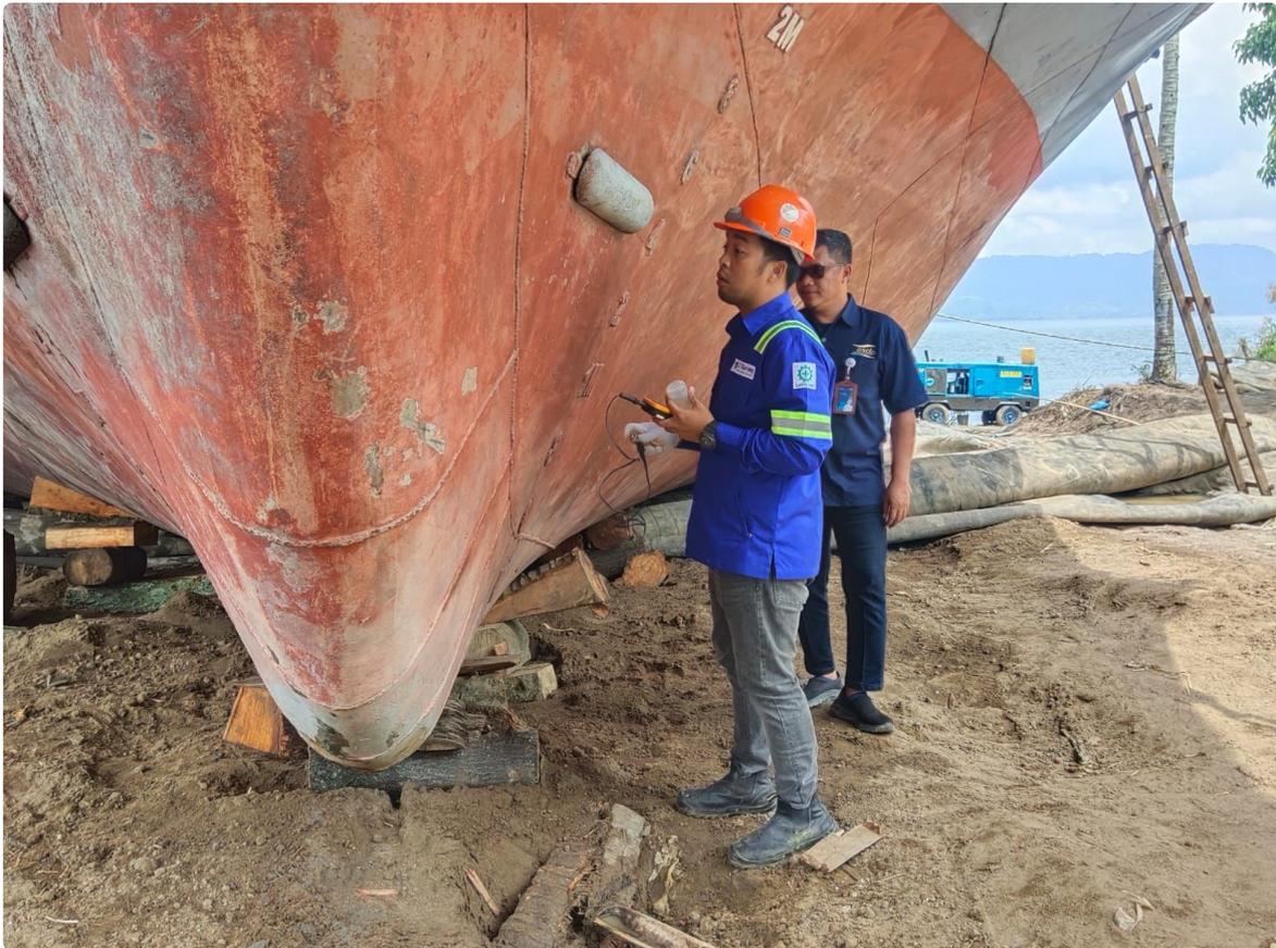
Amatan jurnalis Indonesiasatu.co.id. dilokasi pemeliharaan (docking) Kapal Motor Penyeberangan (KMP) Pora-Pora, Tim BKI melakukan pemeriksaan ketebalan pelat dengan pengujian ultrasonic thickness dan dalam pemeriksaan ketebalan plat tersebut, tidak ditemukan kekurangan ketebalan plat
